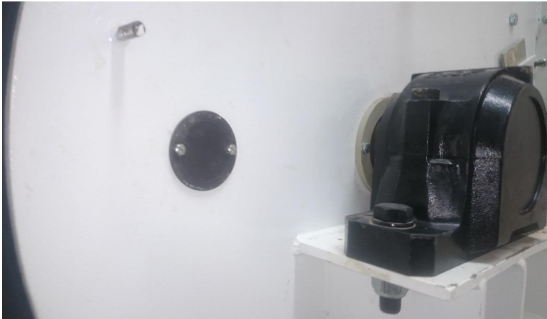
Figure 2: Enlever les côtés de remplacement du marteau placés sur les deux têtes du broyeur
